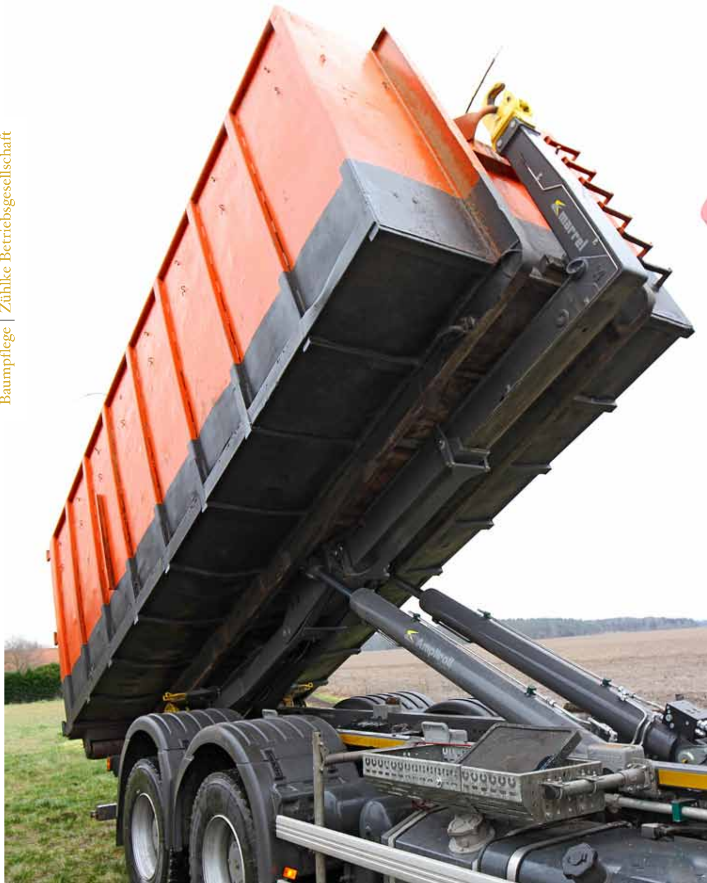
Das Marrel AL 20 S Hakengerät in Kippstellung. Die standardmäßige Position zur Entladung des Restholzcontainers
