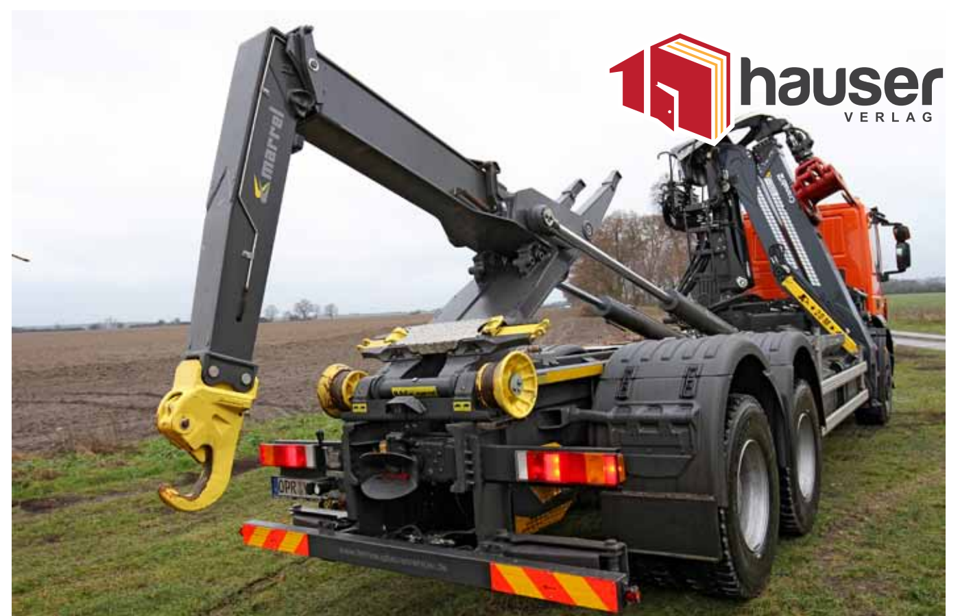
Auch aus der Kipp-Position kann das AL 20 S den Container absetzen. Oberhalb der Laufrollen die umsteckbaren Halteklauen
