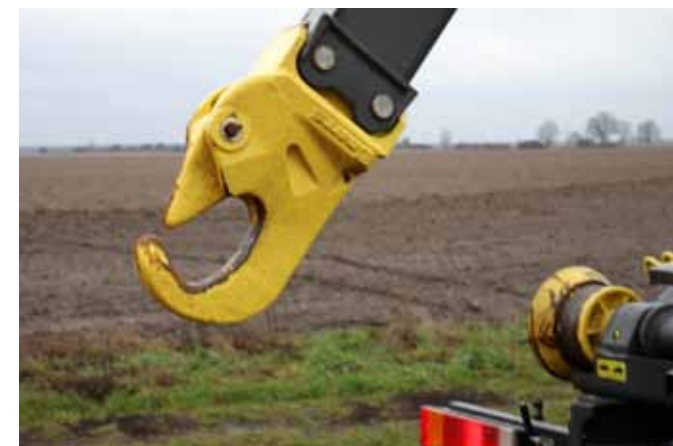
Die hydraulisch in Schließposition gebrachte Hakensicherung
