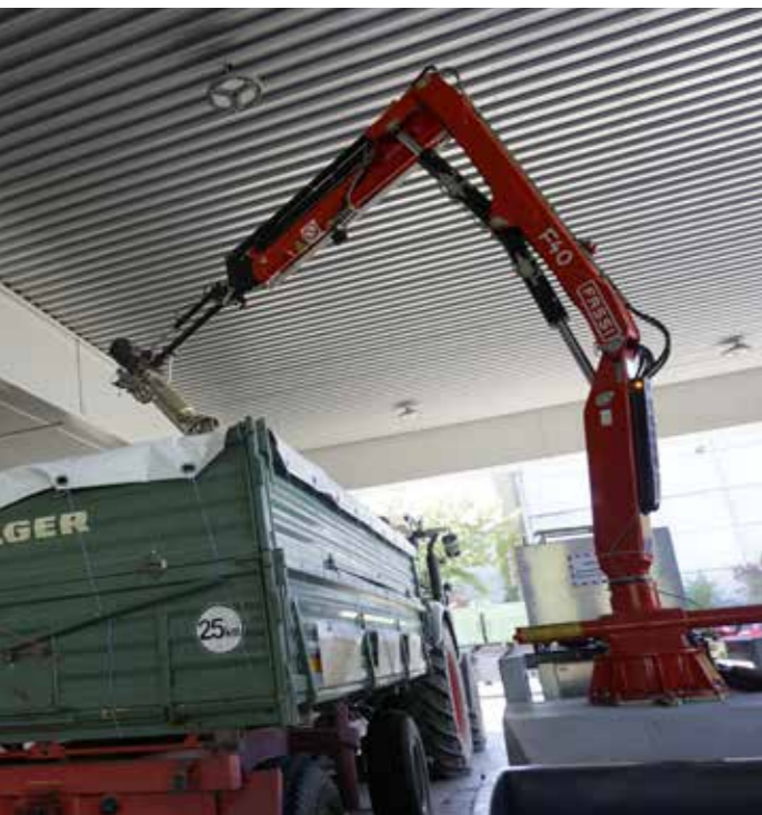
Oben: Ein Fassi F40 Hydraulikkran leitet den Messvorgang ein, die Oechslepumpe ermittelt den Oechslewert Rechts: Bocksbeutel-Flaschen auf der Abfüllanlage
