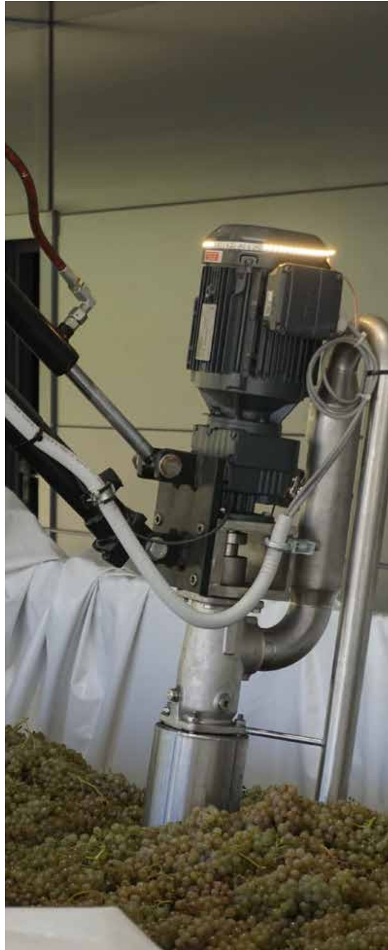
Per Fernsteuerung positioniert GWF-Mitarbeiter Hilmar Streng die Oechslepumpe auf dem mit Trauben beladenen Wagen
